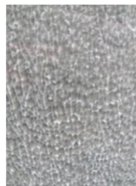
Образец стекла с «правильной закалкой»
