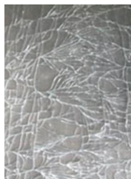
Образец стекла с нарушением технологического процесса
